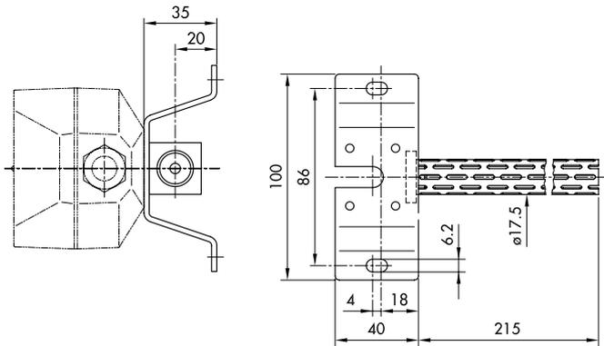
**Befestigungsbügel mit Schutzrohr
