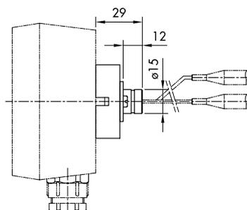
**Konsole mit Befestigungsflansch
