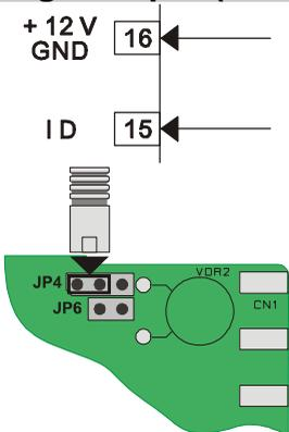
Digital input using parameter `DCI.L`
