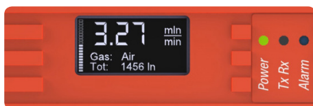
Fig.1 Display SPOT with default parameters
